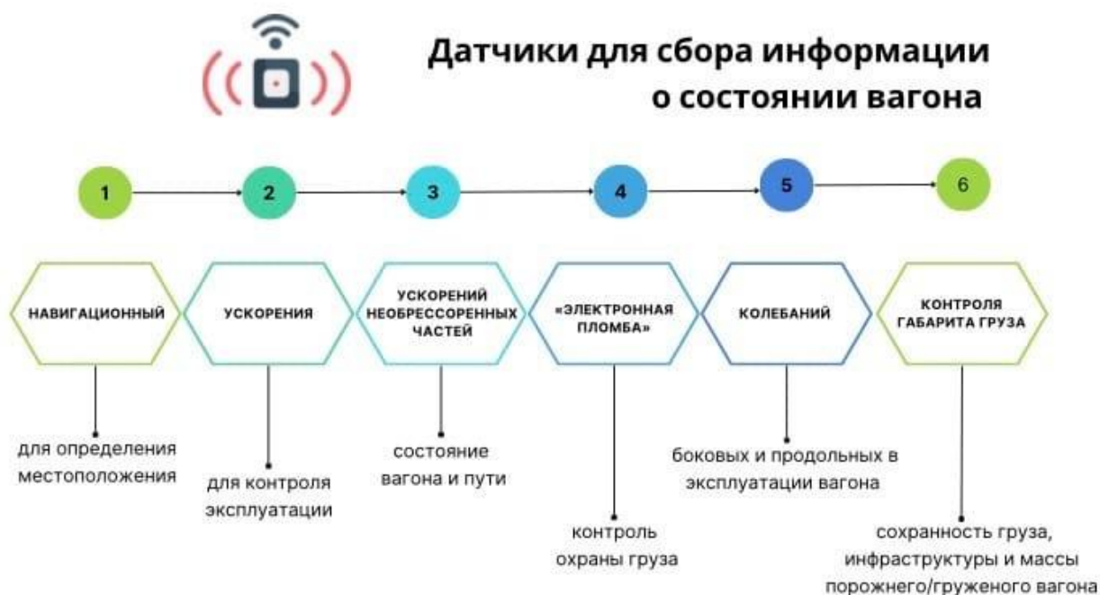
Рисунок 2 – Датчики для сбора информации о техническом состоянии вагона
