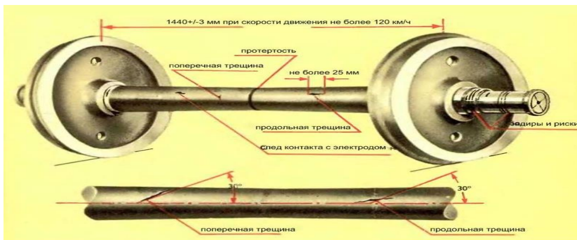
Рисунок 1 – Дефекты оси колесной пары
