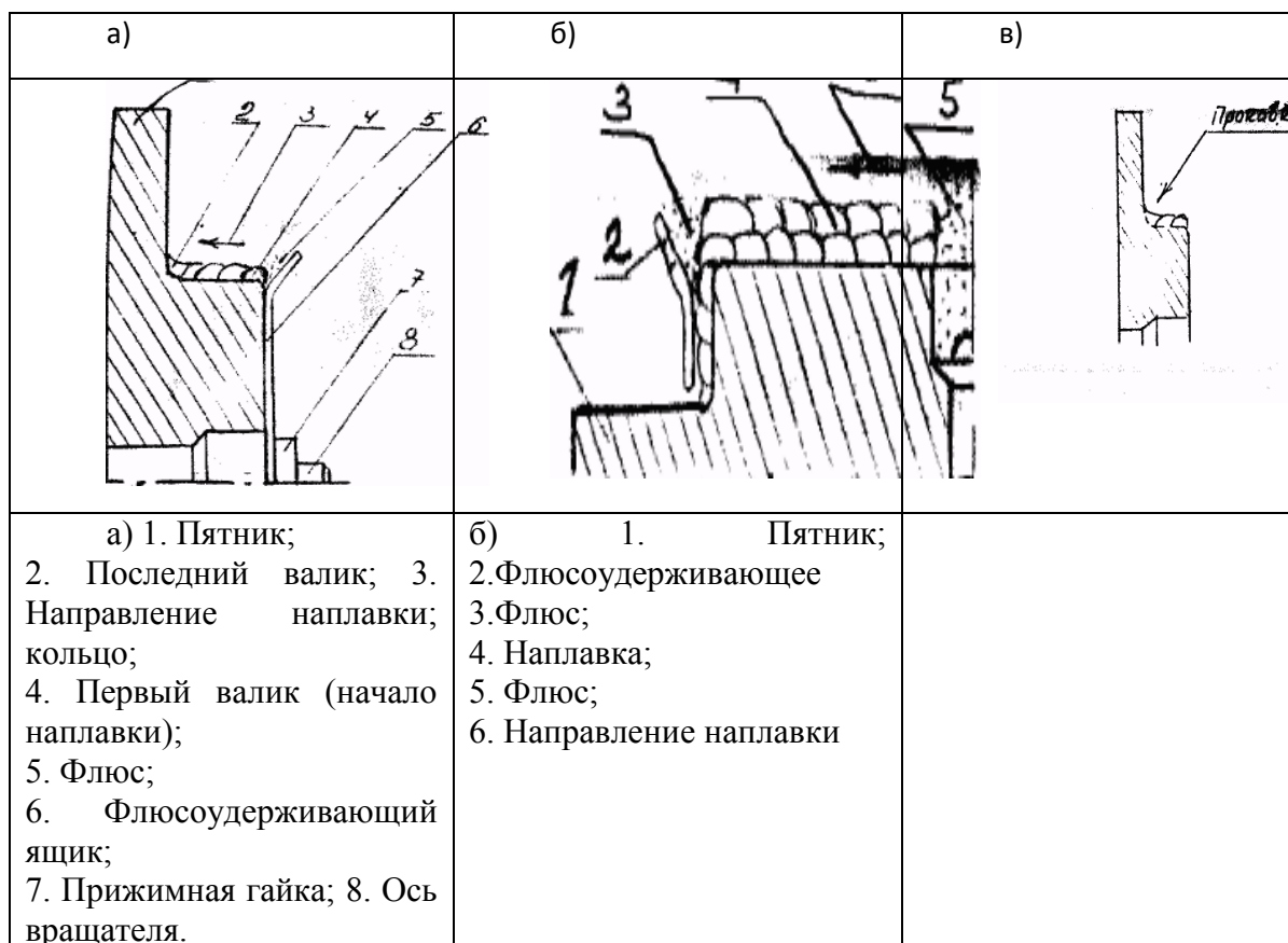
Рисунок 2 – Наплавка пятника
